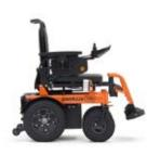
Шасси и рама из массивных стальных труб отличаются прочностью и выдерживают нагрузку до 180 кг.
