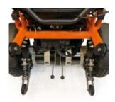
Два независимых мотора - по 500 Ватт каждый позволяют преодолевать угол наклона до 15 градусов без разгона, а также развивать скорость до 10 км/час.
